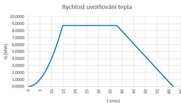
Obr. 3 (A) Vstupní hodnoty pro graf HRR; (B) Vstupní graf HRR pro simulaci
