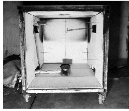
Obr. 3 Zkušební pec miniFUR s viditelným plynovým hořákem uprostřed [6] Fig. 3 Test furnace miniFUR with a visible sand burner in the middle [6]
