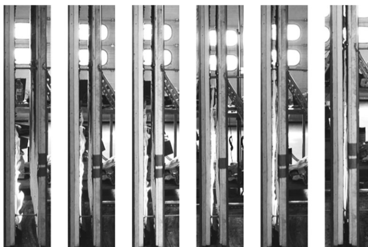
Obr. 3 Fotografie výšky plamene v sestavách s proměnnou šířkou dutiny zleva: 100, 60, 50, 40, 30 a 20 mm [1] Fig. 3 Photographs of flame height in variable cavity width assemblies from the left: 100, 60, 50, 40, 30 a 20 mm [1]
