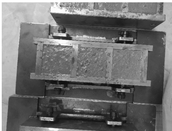
Obr. 1 Příprava vzorků – betonová směs ve formách Fig. 1 Sample preparation – concrete mixture in forms
