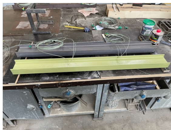
Obr. 2 Podkladní nátěry zkušebních vzorků Fig. 2 Undercoats of test specimen
