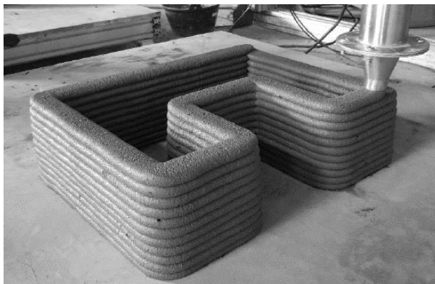
Obr. 1 Tisk cementového kompozitu [2]
