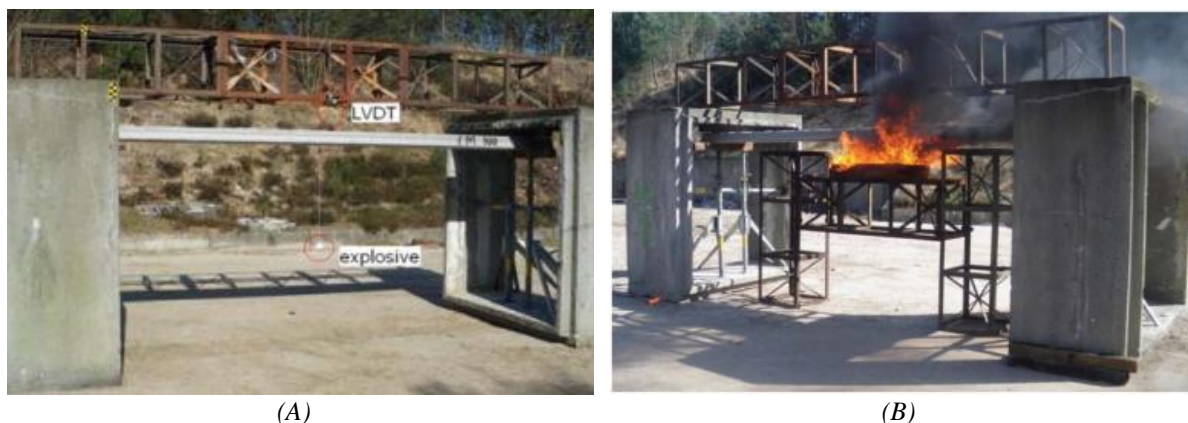
Obr. 2 (A) Nastavení výbuchu; (B) Nastavení požárního zatížení [2] Fig. 2 (A) Blast setup; (B) Experimental setup during the fire loading [2]
