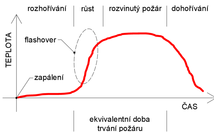
Obr. 1 Graf průběhu požáru s vyznačením jednotlivých fází [1], upraveno Fig. 1 Graph of fire development with marked stages [1], modified
