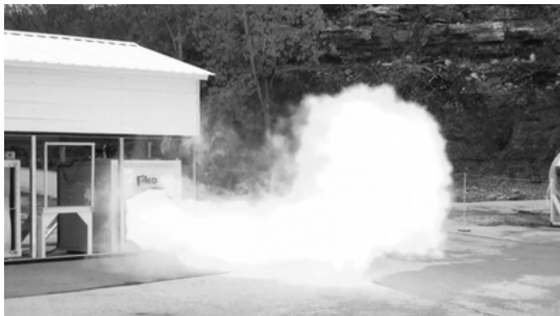
Obr. 3 Nevhodný návrh prvků pro uvolnění tlaku při výbuchu (vhodné místo pro návrh deflektoru) Fig. 3 Improper design of blast vent elements (advisable place for deflector design)
