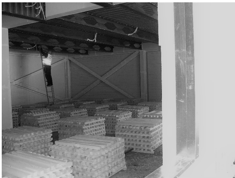
Obr. 1 Požární zkouška Mokrsko Fig. 1 Mokrsko fire experiment
